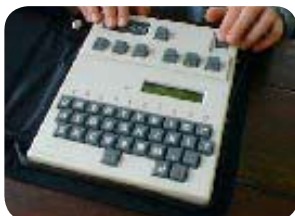
SCREEN BRAILLE COMMUNICATOR Aparato que transcribe, en tiempo real, un mensaje escrito con teclado normal, al Braille y viceversa
