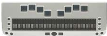
PERIFÉRICO CON TECLADO PARA ESCRIBIR EN BRAILLE Y LÍNEA BRAILLE PARA LEER EL MENSAJE
